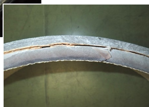
↓ 二層管の層間剥離
