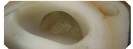
写真4 バルブ内面に発生したブリストー
