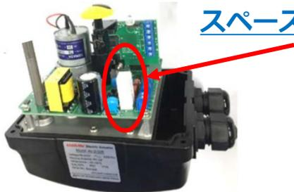
電動式Z型駆動部の内部
