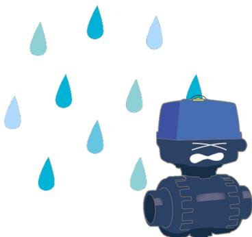
スペースヒータは通電することで発熱し、駆動部内部の結露の発生を抑制し、駆動部内部が錆びたり、配線がショートすることを防ぐ効果があります。
