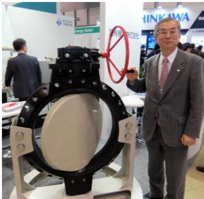
冷却ラインに使用されるバルブは、発電に用いられた蒸気を冷やすため、常時海水を通水するため、腐食が問題となりますが、樹脂 PDCPD 製の大口徑バタフライバルブは高レベルな耐腐食性が期待できます。海水ラインに対して十分な実績があり、さらには軽量かつ短納期でもあります。
