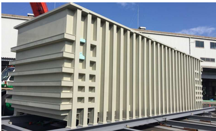
写真 2 分離型タンク (パネルの細分化で陸送が可能)
