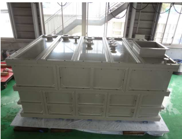
写真1 パネル型タンク
