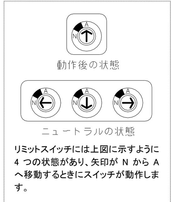
※開度と開度計がずれている場合には、全閉にしてアクチュエータカバーをスパナで緩めて取り外し、スイッチカバーを外して指針を抜き、開度目盛「0」に合わせて指針を押しこみます。
