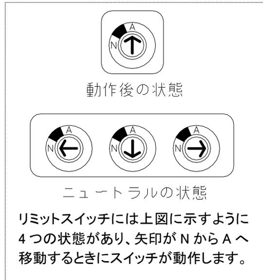
※開度と開度計がずれている場合には、全閉にしてアクチュエータカバーをスパナで緩めて取り外し、スイッチカバーを外して指針を抜き、開度目盛「0」に合わせて指針を押しこみます
